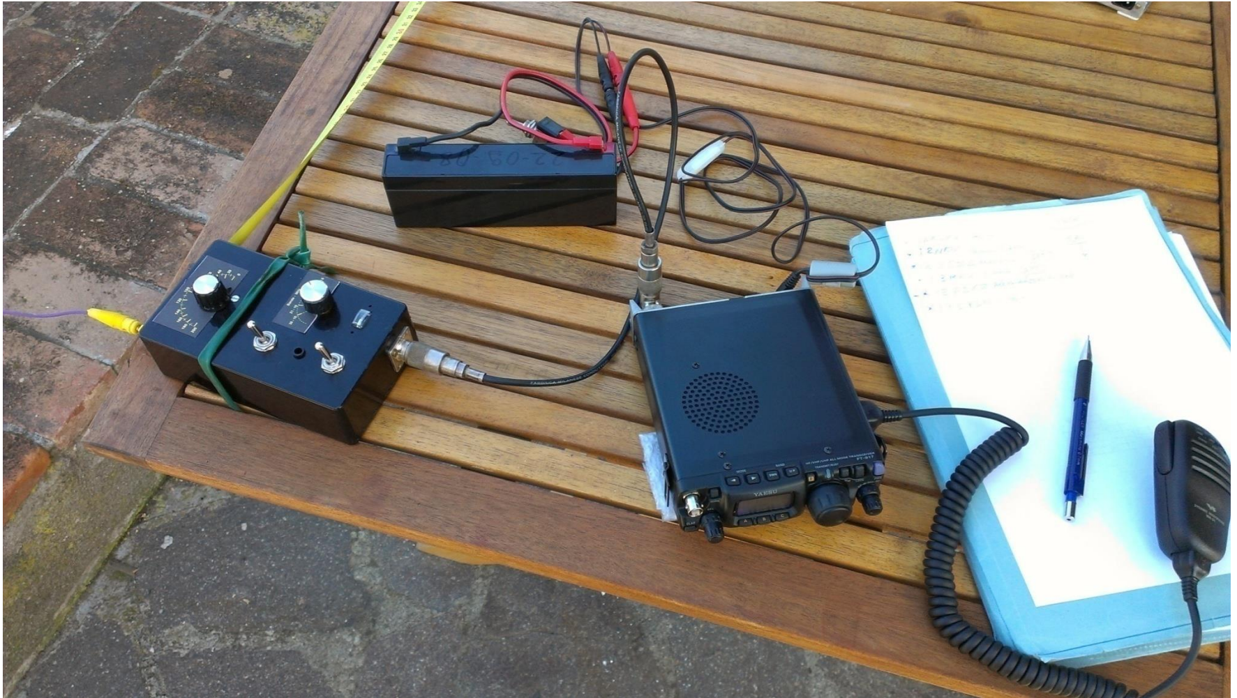
Tipico set-up QRP con EFWA e accordatore
